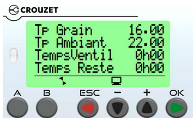
Sur l'écran principal figure les indications suivantes : la température de grain mesuré par la sonde choisi grâce au commutateur multi position, la température extérieure, le temps de ventilation désiré et le temps de ventilation restant.
