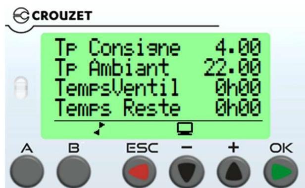
Sur l'écran principal figure les indications suivantes : la température de consigne que vous avez renseignée pour le déclenchement de la ventilation, la température extérieure, le temps de ventilation désiré et le temps de ventilation restant.
