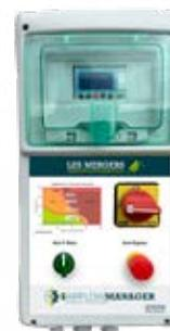
Système conçu pour aider le responsable de silo à gérer les cycles de ventilation, optimisant l'énergie pour le refroidissement des grains et évitant les dépenses inutiles. Programmez simplement une température de déclenchement et une durée de ventilation, puis mettez en AUTO pour un fonctionnement autonome : l'AIRFLOW MANAGER active ou stoppe le ventilateur selon la température extérieure. Compatible avec des installations neuves ou existantes, il offre un historique détaillé des ventilations.
